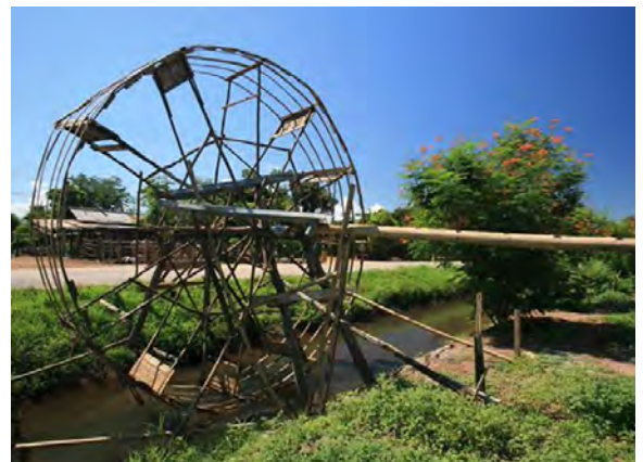
ภาพ 1 “หลูก” กังหันวิดน้ำไม้ไผ่ตามภูมิปัญญาทางภาคเหนือ ที่มา https://twitter.com/samrujlok
