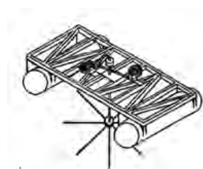
ภาพ 4 เครื่องกลเติมอากาศระบบเป่าอากาศหมุนใต้น้ำ (RX-3)
